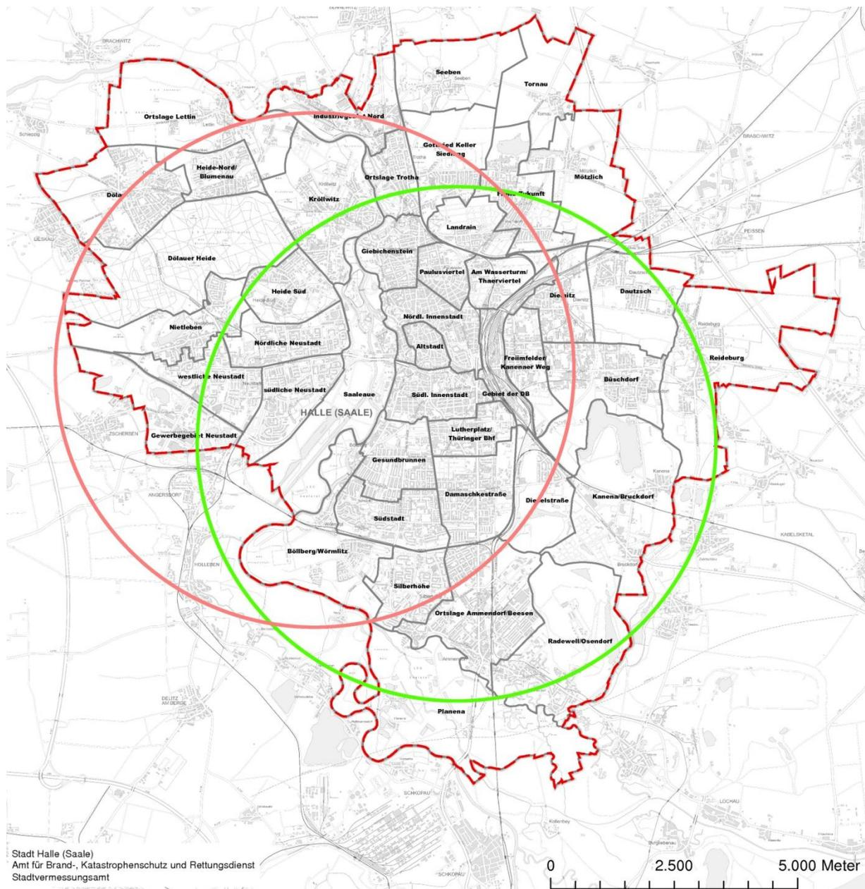
Abbildung 19: Erreichbarkeit Berufsfeuerwehr bei einer Hilfsfrist von 12 min und 2 Wachen
