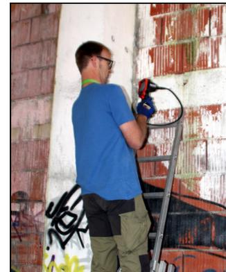
Abbildung 3: Untersuchung von Spalten und Höhlungen mittels Endoskop
