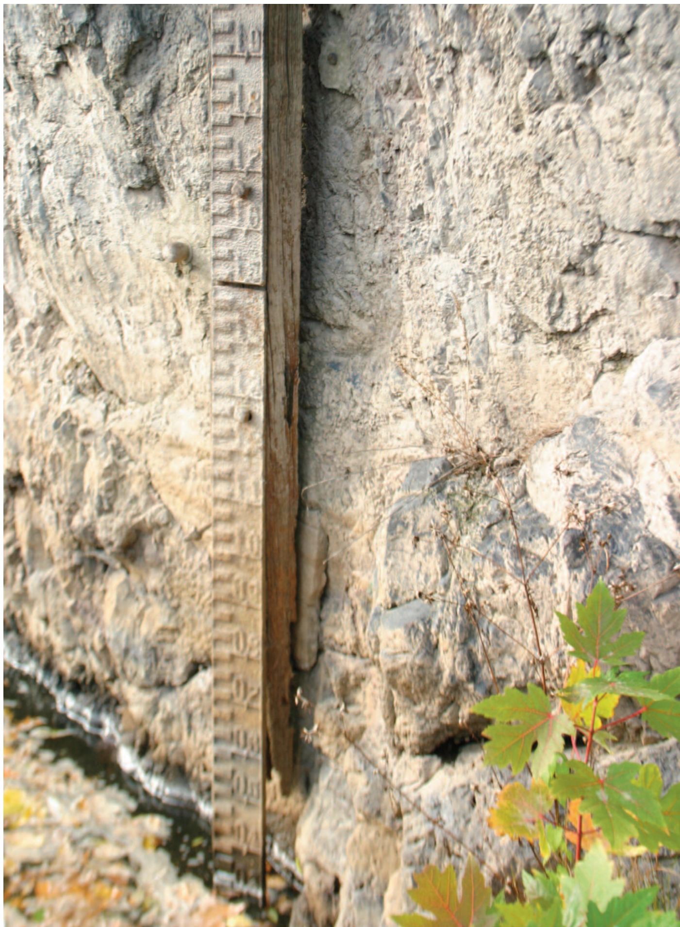
Nr. 4: Pegellatte (Binnenpegel, Gußeisen), talwärts, linksseitiges Ufer (Kröllwitz), unterhalb des Kefersteinschen Felsens, Detailansicht (Ausschnitt)
