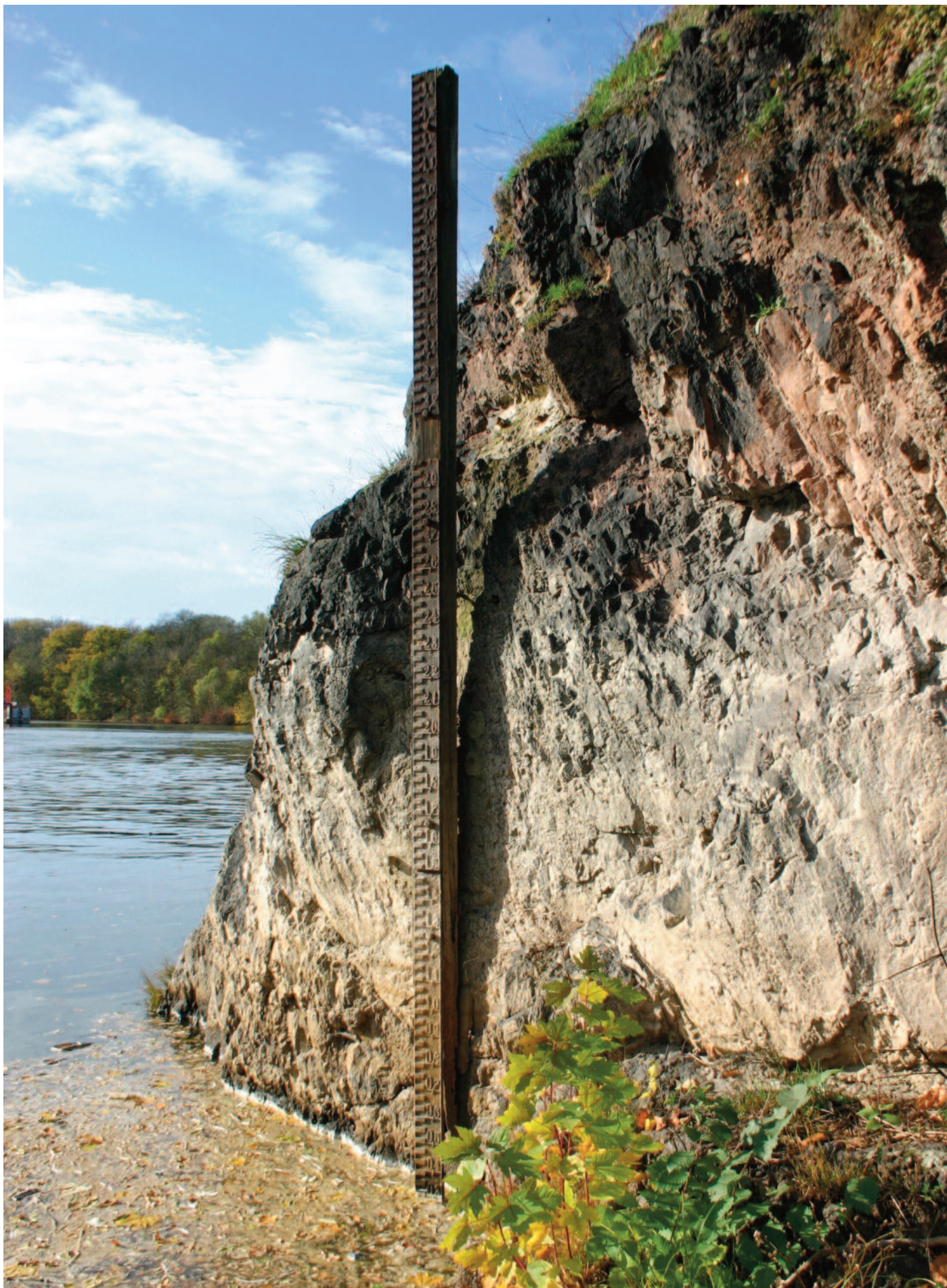
Nr. 4: Pegellatte (Binnenpegel/Lattenpegel, Gußeisen), talwärts, linksseitiges Ufer (Kröllwitz), unterhalb des Kefersteinschen Felsens
