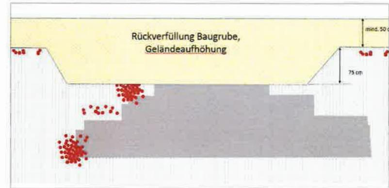
3. Einbau eines tragfähigen Lastverteilungspolsters, außerhalb des Gebäudes Aufbringen von Boden zur Geländeaufhöhung
