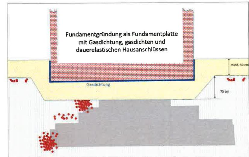
4. Herstellung des Fundamentes mit Gasdichtung unter der Bodenplatte, gasdichte und dauerelastische Hausanschlüsse, Gasabführung etc.<sup>1</sup>
