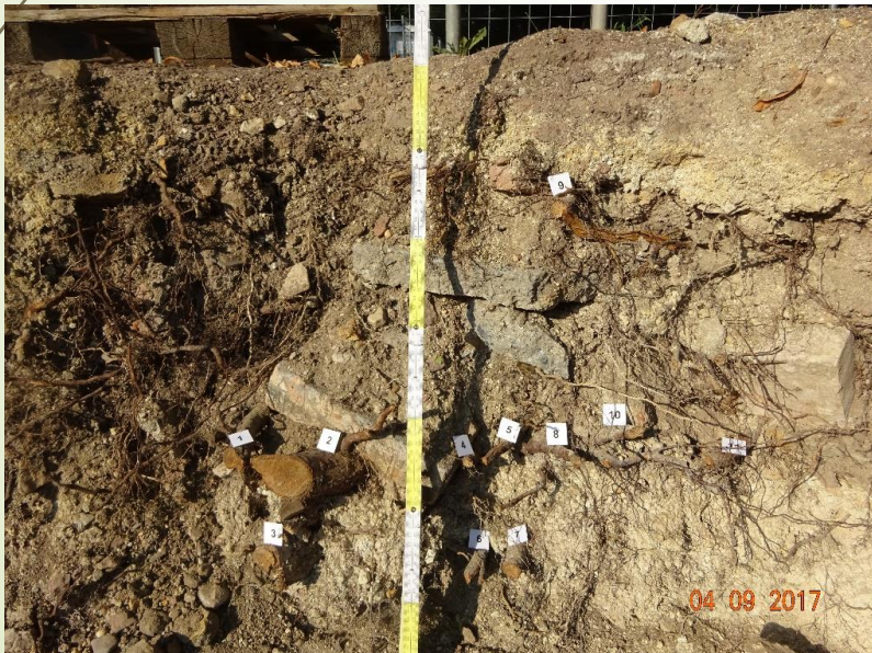
Wurzelschäden durch Mauerabriss bei Baum 154,
