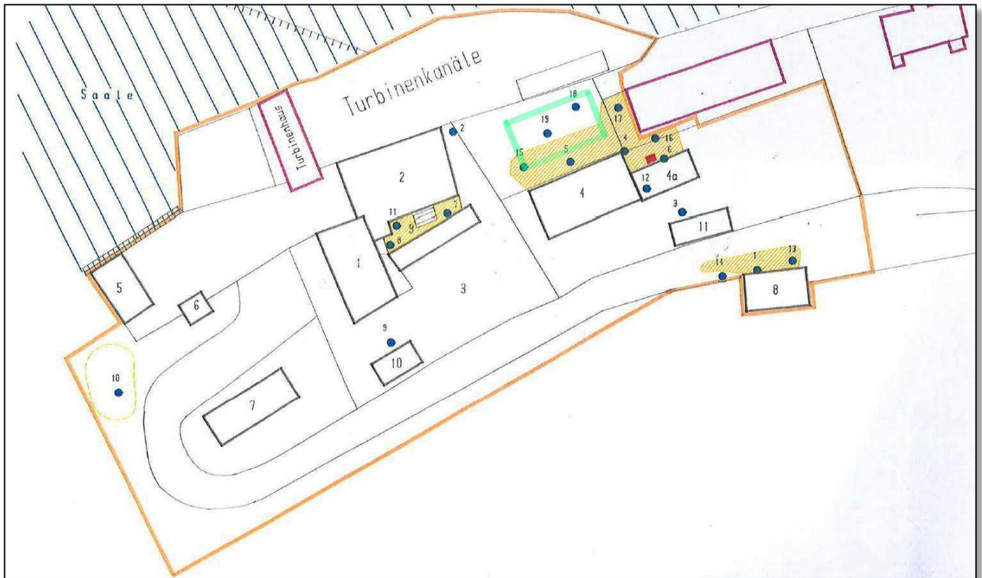
**Bild 3-1:** Lageplan aus [HPC92] mit Gebäuden (große Zahlen) und Sondierpunkten (kleine Zahlen). Das neu zu errichtende Gebäude ist grün eingezeichnet. Achtung, Norden ist links in dieser Darstellung.
