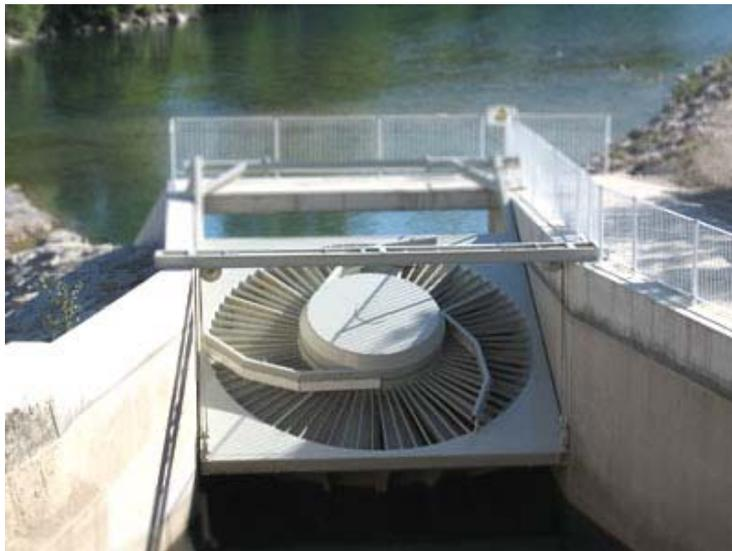
**Bild 3** Unterwasserturbine (Prinzip)
