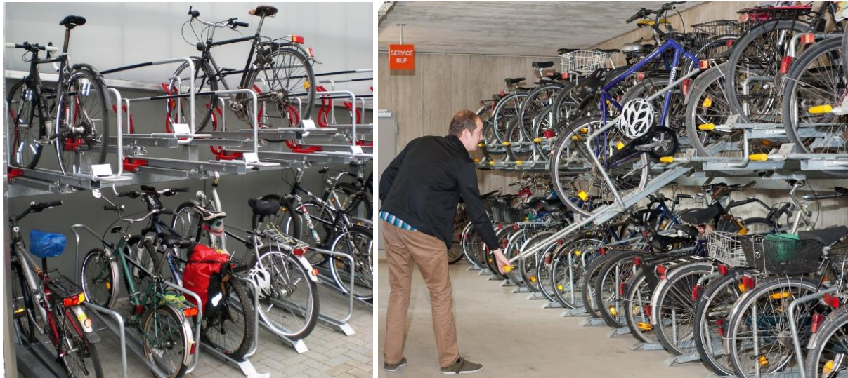
Abb. 9 Praxisbeispiel Doppelparker der Firma Orion 12
